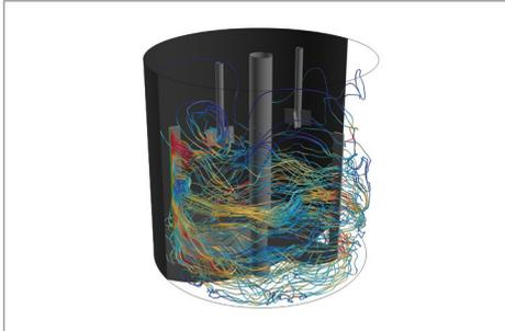
攪拌タンク内の流動パターンを示す流線
