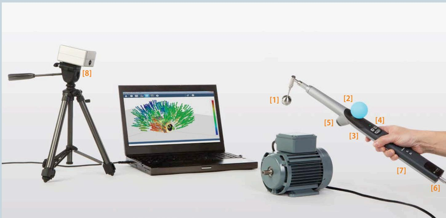
**[1] マイクロホンアンテナを装着して計測**
