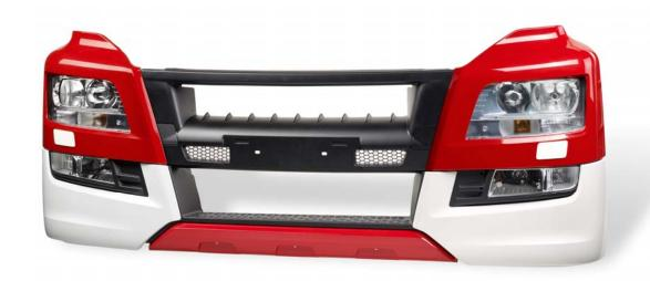
高度に強化されたポリアミド 6「デュレタン DP BKV 60 H2.0 EF」が使用された TGX と TGS のヘッドランプサポート。ヘッドランプサポートに接続するU字型センターフロントステップは、PET+ PBT ブレンドの「ポカン TS 3220」を使用し射出成形されます。
