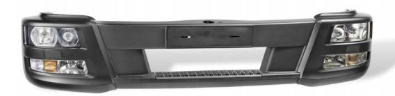
高度に強化されたポリアミド 6「デュレタン DP BKV 60 H2.0 EF」が使用された TGL と TGM のヘッドランプサポート。センターカバーとヘッドランプカバーは、非強化 PET+PC ブレンドの「ポカン C 1206」が使用されています。
